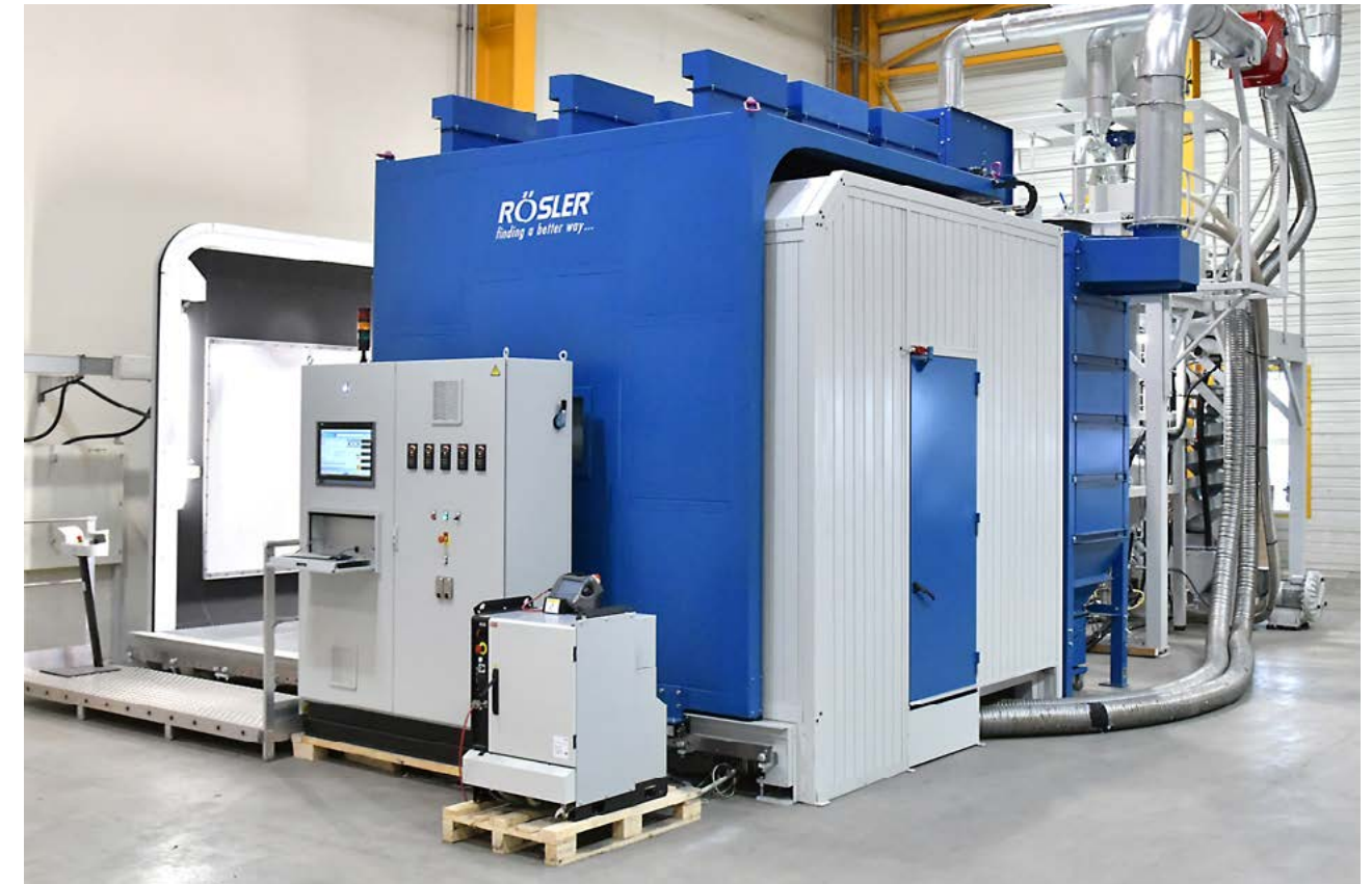
External view of the robot-operated shot - peening machine Roesler ALS 2800 RP
