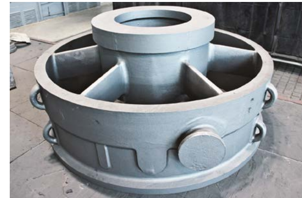
LPT exhaust plenum
